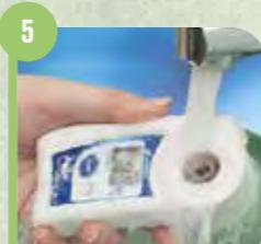
Očistimo i osušimo površinu prizme – lijevka uređaja
